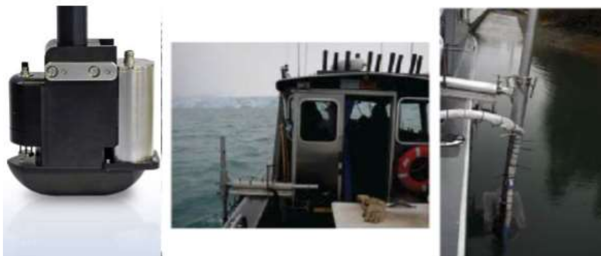
Fig.15 Sistema GeoSwath montato a bordo dell'imbarcazione
